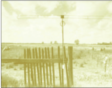
Bild 3: Der mit einem Mikrowattsender gespeiste Dipol für die Vergleichsmessungen
