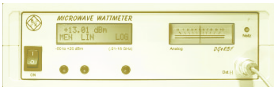
Bild 1: Frontplatte des Geräts mit neu programmierter Displayanzeige; deutlich ist die Beschriftung der Tastenfunktionen LIN und LOG zu erkennen. Das analoge Instrument arbeitet hier im linearen Mittenbetrieb, der Leistungsabweichungen besser verdeutlicht.
