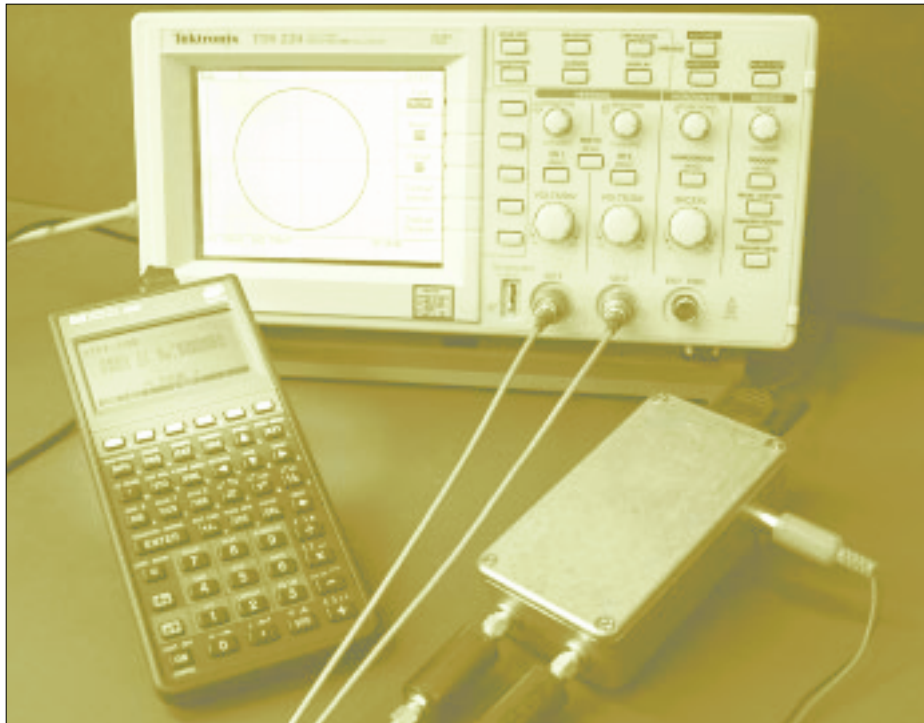
Bild 1: Fertig aufgebauter DDS-Oszillator mit HP48-Steuerrechner. Der Meßaufbau zeigt auf dem in XY-Darstellung arbeitenden Oszilloskop einen perfekten Kreis.
